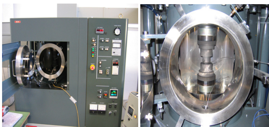
شکل ۲- محفظه خلأ و محور اعمال فشار [9]
