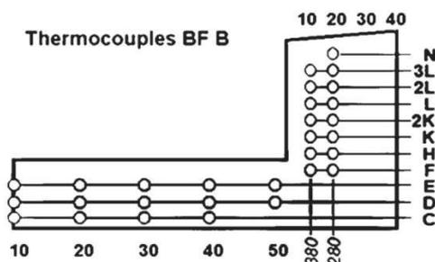
شکل ۱۴- مکان قرارگیری ترموکوپل‌ها در هارت کوره [۱۱]
