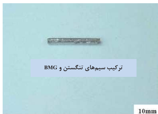
شکل ۶- کامپوزیت شیشه فلز حجمی- تنگستن [۹]
