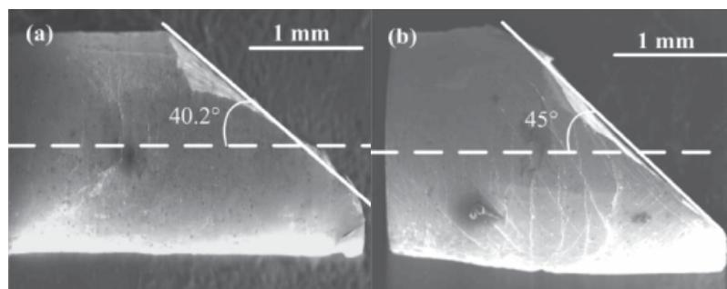
شکل ۲- تصویر SEM از مقطع شکست نمونه آلیاژ آمورف (a)  $\text{Cu}_{47.5}\text{Zr}_{47.5}\text{Al}_5$  (b)  $\text{Cu}_{50}\text{Zr}_{50}$  پس از آزمایش فشار سرد [۶]
