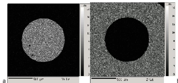
شکل ۷- تصویر پرتو X از فیبر تنگستن و زمینه شیشه فلز با استفاده از (a) Zr La (b) W La
