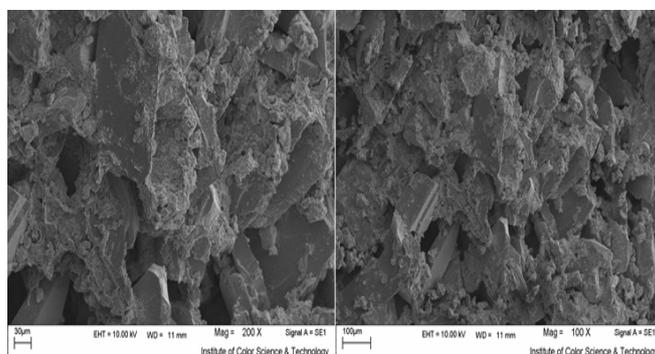
شکل ۷- تصویر از نمونه A<sub>3</sub> خام ریخته‌گری ژلی شده پودر سیلیسیم کاربرد در دو بزرگ‌نمایی متفاوت تصویر از نمونه A<sub>3</sub> خام ریخته‌گری ژلی شده پودر سیلیسیم کاربرد در دو بزرگ‌نمایی متفاوت
