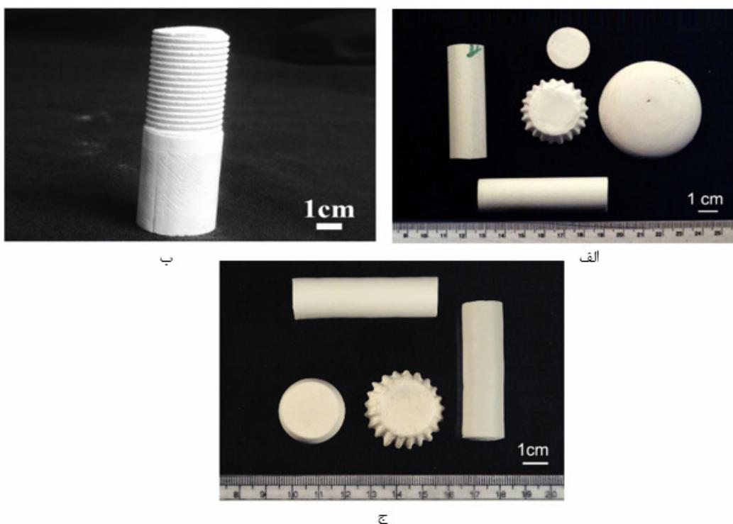
شکل ۴- نمونه‌های آلمینایی تهیه شده با روش ریخته‌گری با سخت کردن نشاسته
