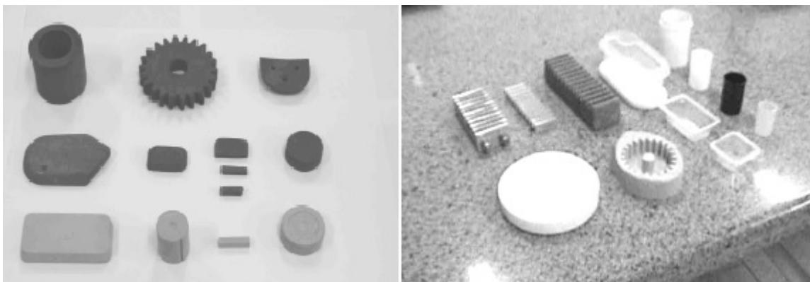
شکل ۳- (الف) قالب‌های استفاده شده، (ب) قطعات  $\text{SiC}$  تهیه شده با روش ریخته‌گری با ساخت کردن نشاسته [۹].
