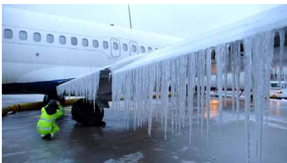
شکل ۱۹- رشد شدید یخ بر روی بال‌های هواپیما [۲۲].
