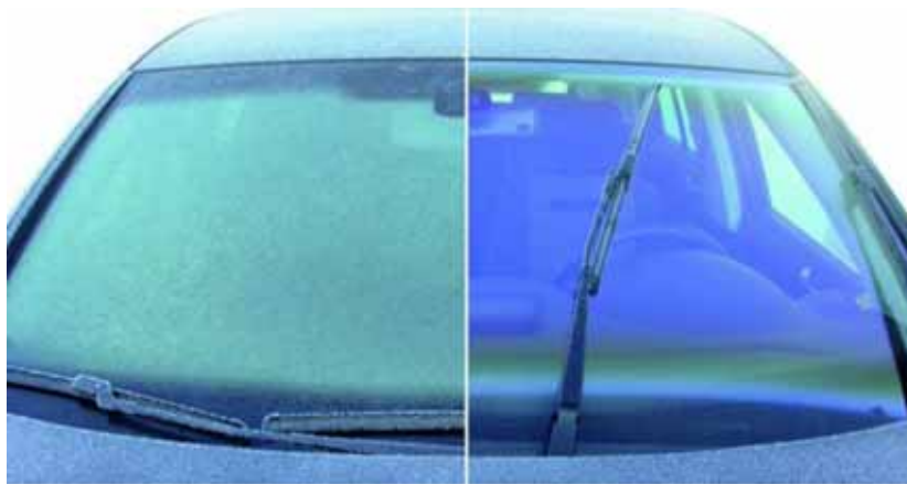
شکل ۲۰- اعمال پوشش فوق آبگریز ضدیخ بر روی شیشه اتومبیل باعث عدم تشکیل یخ بر روی سطح شیشه می‌شود [۲۳].
