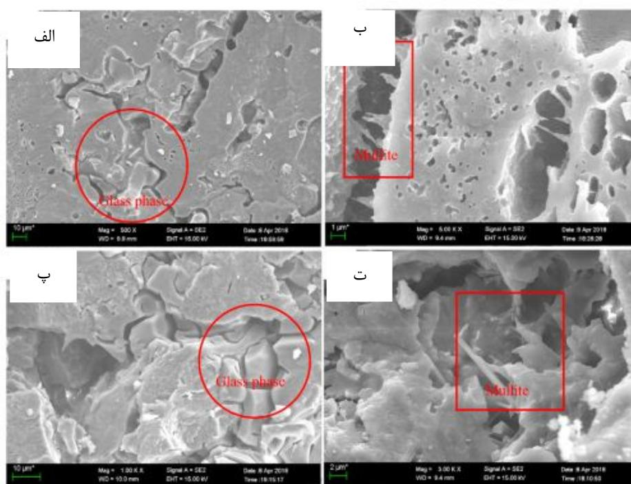
شکل ۷ - تصویر SEM . (الف) نمونه حاوی  $\text{N}_2\text{O}$  کلسینه شده در  $1200^{\circ}\text{C}$  درجه سانتی گراد. (ب) کلسینه شده در  $1350^{\circ}\text{C}$  درجه سانتی گراد. (پ) نمونه حاوی  $\text{K}_2\text{O}$  کلسینه شده در  $1200^{\circ}\text{C}$  درجه سانتی گراد. (ت) کلسینه شده در  $1350^{\circ}\text{C}$  درجه سانتی گراد[۱۴].
