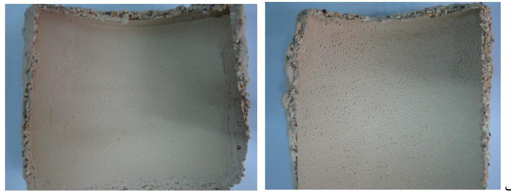
شکل ۲-مورفولوژی سطح پوسته سرامیکی (الف) الگوی فوم بدون پوشش در سطح پوشش‌ها (ب) الگوی فوم پوشش داده شده با صاف کردن سطح [۱۰].
