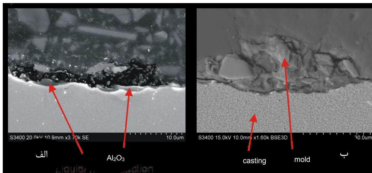
شکل ۱- واکنش بین قالب و مذاب ریخته گری شده. (الف) تشکیل یک لایه آلمینیا در اثر واکنش بین سیلیکا از قالب سرامیکی و آلمینیوم موجود در مذاب. (ب) تشکیل لایه اکسیدی در سطح قطعه و قالب [۹].
