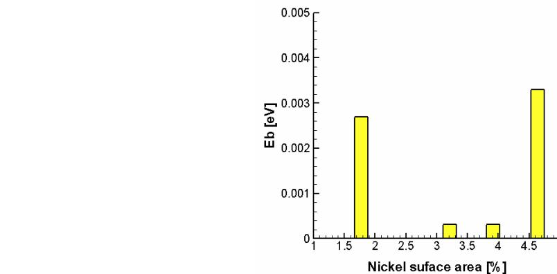
شکل ۲- تغییرات انزی سدهای تانسیل بین نانوذرات روی سطح برای لایه‌های انباشت شده در نسبت‌های سطحی مختلف نیکل ۱/۷۸، ۳/۹۲ و ۴/۶۴ درصد.
