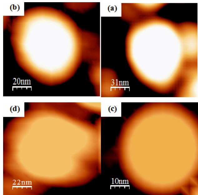
شکل ۳- تصاویر میکروسکوپ نیروی اتمی AFM نانوذرات روی سطح لایه‌ها را در نسبت‌های سطحی مختلف نیکل ۱/۷۸، ۳/۹۲، ۴/۶۴ و ۳/۲۱ (a) تا ۳/۹۲ (b) درصد.
