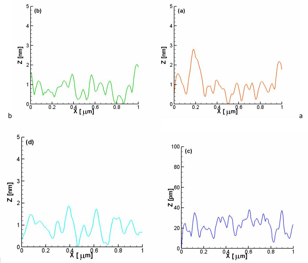
شکل ۱- تغییرات ارتفاع Z نانوذرات روی سطح بر حسب محور X برای لایه‌های انباشت شده در نسبت‌های سطحی مختلف نیکل ۳/۹۲(c) ۳/۲۱(b) ۱/۷۸(a) ۴/۶۴(d) درصد.
