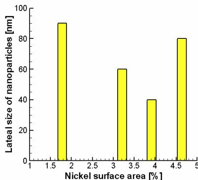
شکل ۴- تغییرات اندازه عرضی نانوذرات روی سطح لایه‌ها برای لایه‌های انباشت شده در نسبت‌های سطحی مختلف نیکل ۳/۹۲، ۳/۲۱، ۱/۷۸ و ۴/۶۴ درصد.
