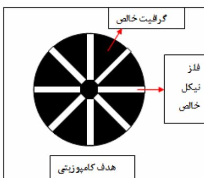
شکل ۱- تصویر شماتیکی هدف کامپوزیتی گرافیت و نیکل.
