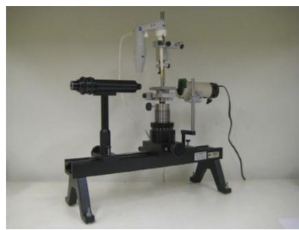
شکل ۱۷- تلسکوپ زاویه سنج - گونیومتر [۳۴].
