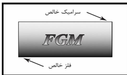
شکل ۱- نمایی شماتیک از ماده FGM با ترکیب سرامیک- فلز
