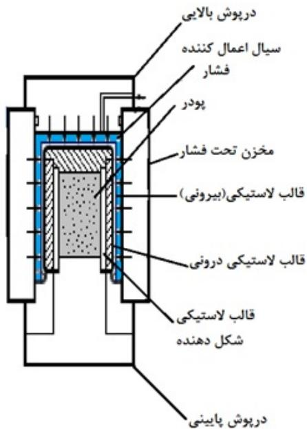
شکل ۲ - شماتیک روش پرس سرد ایزوساتاتیک [۲۲ و ۲۳].
