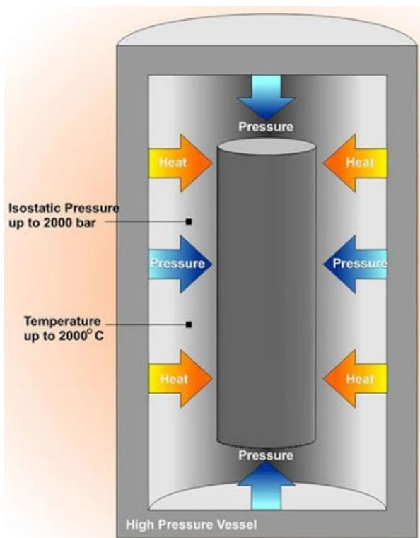
شکل ۳ - شماتیک روش پرس ایزوساتاتیک گرم [۲۲ و ۲۳].
