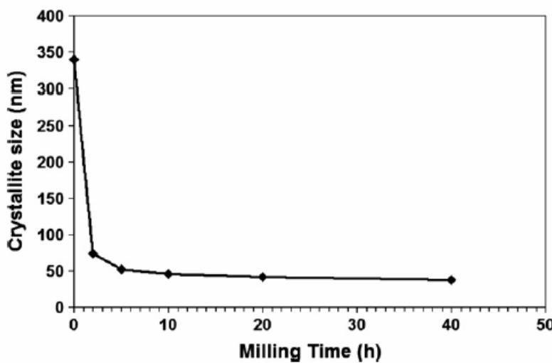
شکل ۶- تغییرات اندازه دانه Al در حین آسیا برای نمونه Al-10Wt.%B<sub>4</sub>C [۲۸].
