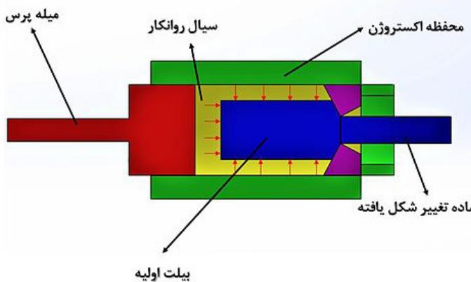
شکل ۱ - شماتیک روش اکستروژن [۲۲].
