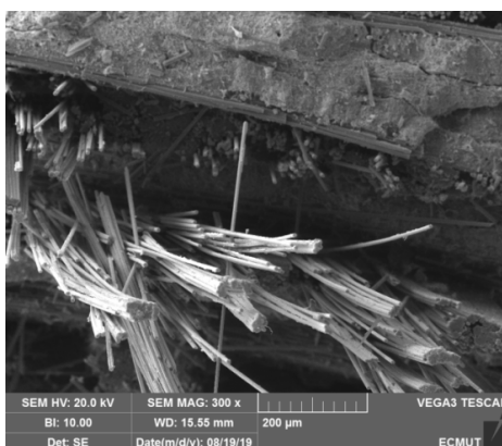
شکل ۴- سطح شکست کامپوزیت پس از بارگذاری خمشی
