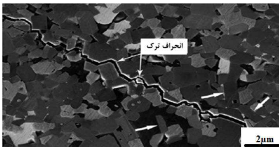
شکل ۲- مسیر رشد ترک و تصویر میکروسکوپی سطح پرداخت شده کامپوزیت \text{TiB}_2 - \text{SiC} [۳۶].
