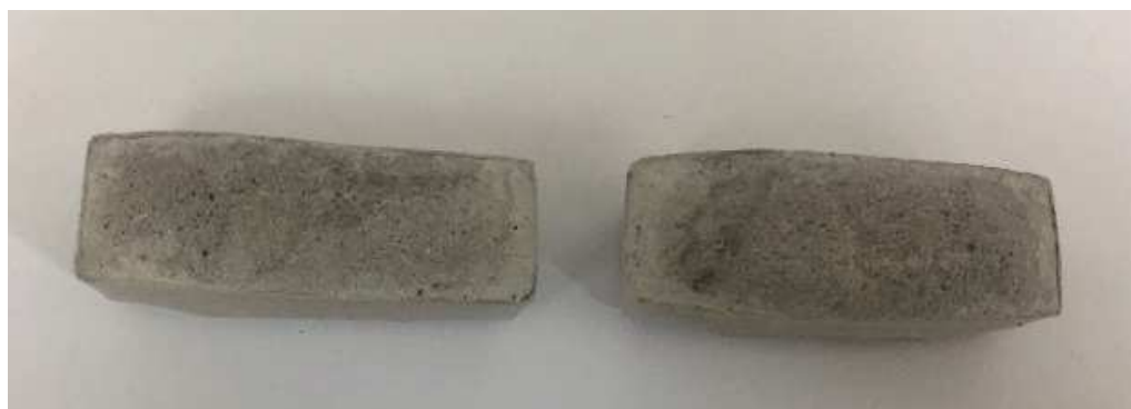
شکل ۱-۳: تصویر نمونه ژئوپلیمری با ترکیب بهینه بعد از پخت در دمای 1000^{\circ}C
