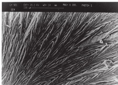
شکل ۷- ریزساختار نمونه GC.۴ پس از عملیات حرارتی (بزرگنمایی ۳۰۰)
