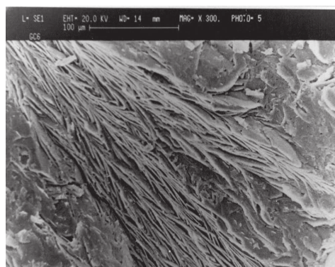
شکل ۹- ریزساختار نمونه GC.۶ پس از عملیات حرارتی (بزرگنمایی ۳۰۰)
