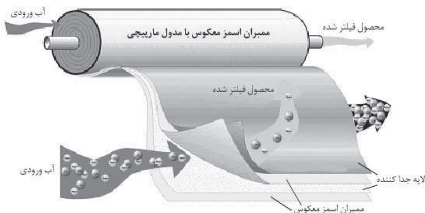
شکل ۶- نمای شماتیک ممبران مارپیچی [۵]
