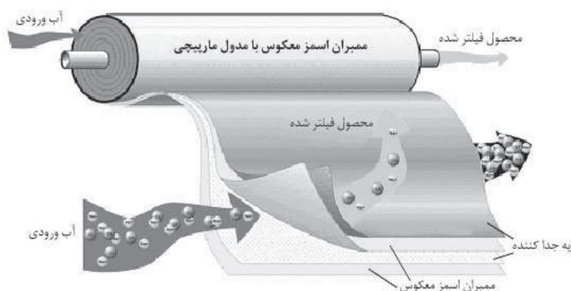
شکل ۶- نمای شماتیک ممبران مارپیچی [۵]
