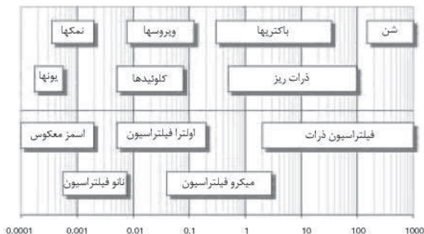
شکل ۳- محدوده اندازه حفره ممبرانهای با گرادیان فشار به همراه آلودگیهایی که در حذف آنها موثرند (اعداد بر حسب میکرون بیان شده اند) [۶]
