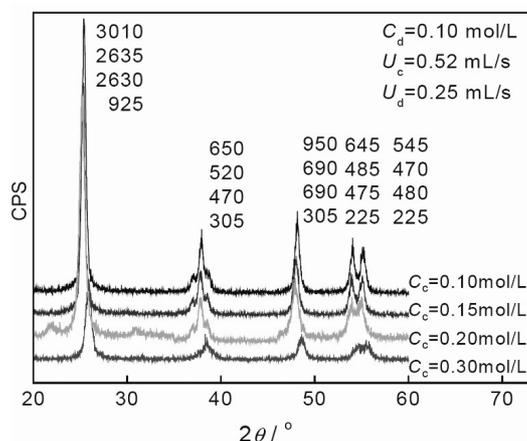
شکل ۱۰- الگوی XRD نانوذرات  $\text{TiO}_2$  در غلظت‌های مختلف مواد واکنش دهنده [۲۸]
