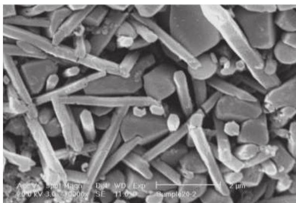
شکل ۵- تصویر SEM از سطح مقطع شیشه سرامیک حاصل از سینتر ۵۰٪ شیشه میکا و ۵۰٪ شیشه A/W [۲۶]
