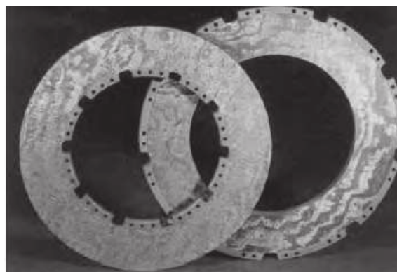
شکل ۴- دیسک‌های ترمز هواپیمای غیر نظامی از جنس کامپوزیت C/C [۴]
