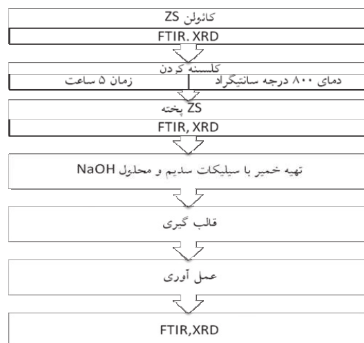
شکل ۱- شمای روند ساخت و بررسی تحولات ساختاری سیمان ژئوپلیمری حاصل این تحقیق
