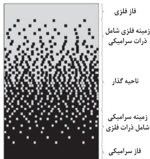
شکل ۱- طرح‌واره‌ای از ساختار یک نمونه FGM [۲]
