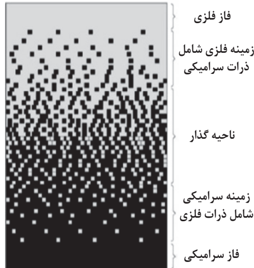
شکل ۱- طرح‌واره‌ای از ساختار یک نمونه FGM [۲]
