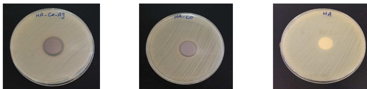
شکل ۵. میزان فعالیت های ضدباکتریایی نمونه های سنتز شده در برابر باکتری گرام منفی.
