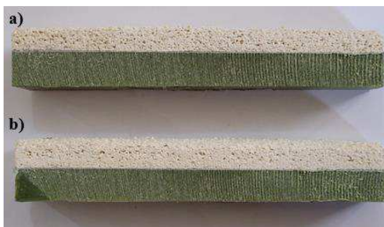
شکل ۱. نمونه‌های لایه داده شده قبل از مومزدایی (a) نمونه A، (b) نمونه B
