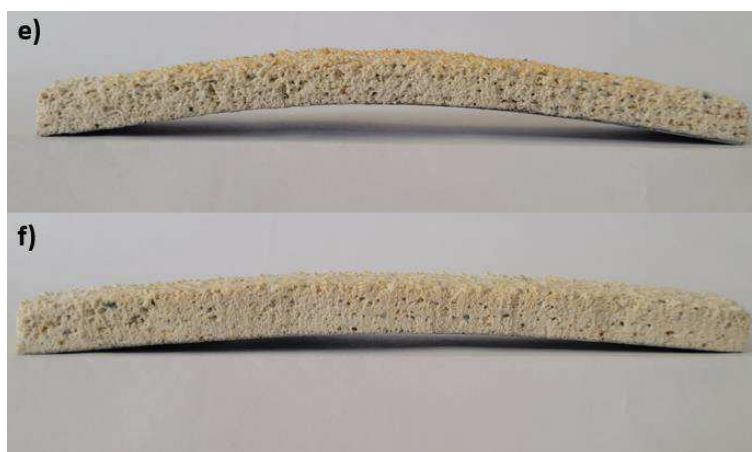
شکل ۷. مقاومت به شکم‌دهی نمونه‌های پخت‌شده در دمای ۱۵۰۰ درجه سانتی‌گراد: (e) نمونه تهیه‌شده با دوغاب A، (f) نمونه تهیه‌شده با دوغاب B.
