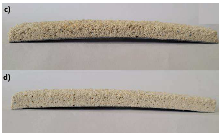
شکل ۶. مقاومت به شکم‌دهی نمونه‌های پخت‌شده در دمای ۱۴۵۰ درجه سانتی‌گراد: (c) نمونه تهیه‌شده با دوغاب A، (d) نمونه تهیه‌شده با دوغاب B.
