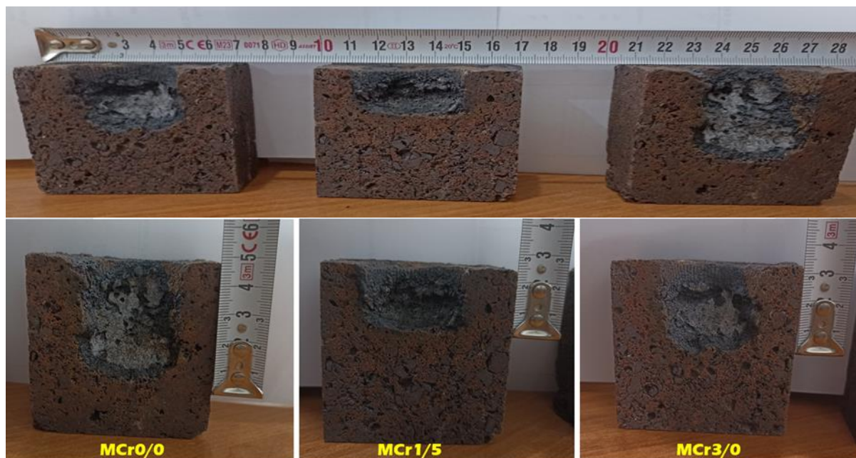
شکل ۸: تصاویر مربوط به سطح مقطع و میزان عمق خوردگی نمونه‌های فاقد و شامل ۱/۵ و ۳ درصد افزودنی کرومیا پس از آزمون مقاومت به خوردگی
