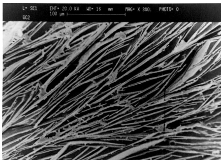
شکل ۵- ریزساختار نمونه GC.۲ پس از عملیات حرارتی (بزرگنمایی ۳۰۰)
