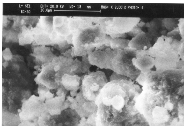
شکل ۲- تصویر میکروسکوپ الکترونی بخش پودری سیمان قبل از مخلوط شدن با فاز مایع
