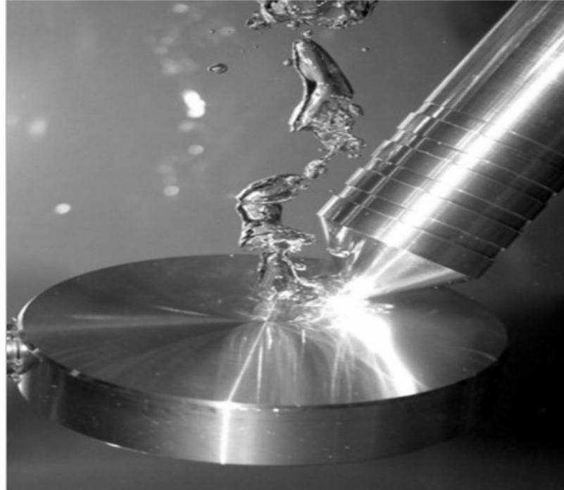
شکل ۷- آنالیز مواد فلزی در زیر آب با تکنیک LIBS
