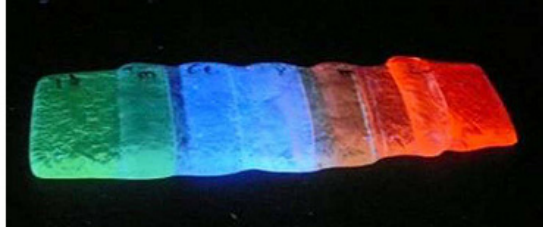
شکل ۳- همجوشی شیشه سیلیکات سودا-لایم با اکسیدهای حاکی کمیاب. از چپ به راست: تربیم، تولیوم، سریوم، دیسپروسیوم، ساماریوم و یورویوم [۹].
