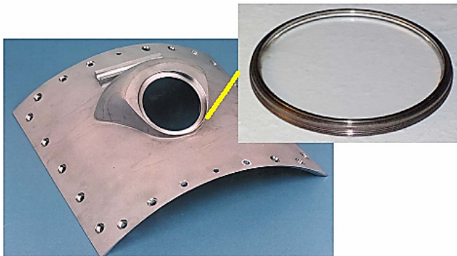
شکل ۶- محافظ سنسور مادون قرمز در هواپیماهای رهگیری کننده مافوق صوت [۳].
