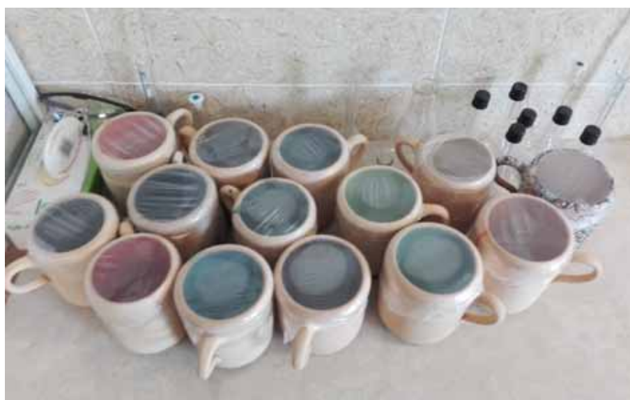
شکل ۱- (بخش الف) لیوان‌های لعاب‌دار و (بخش ب) لیوان‌های حاوی محلول اسید استیک ۴٪
