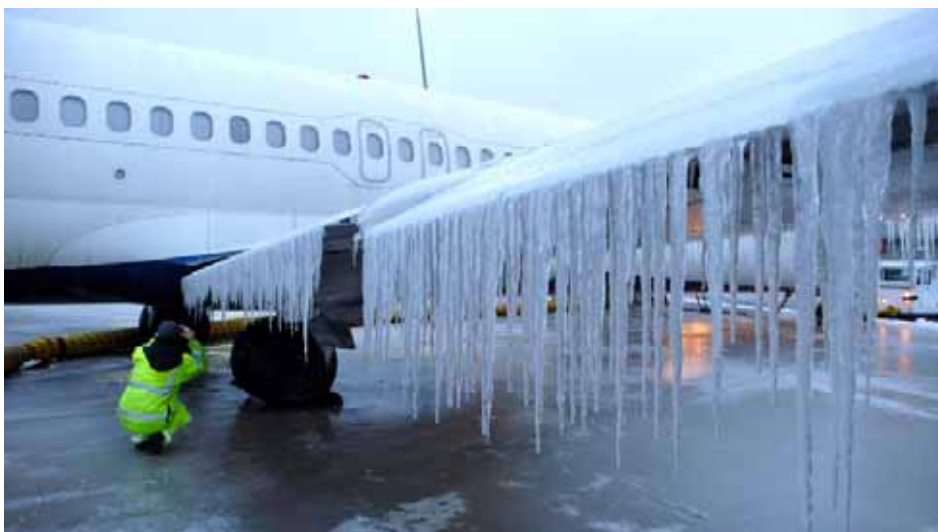
شکل ۱۹- رشد شدید یخ بر روی بال‌های هواپیما [۲۲].
