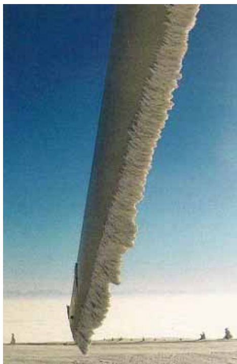
شکل ۲۱- انباشت یخ بر روی پره یک توربین بادی [۲۴].
