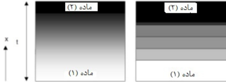
شکل ۹- طرح‌واره دو ساختار FGM: سمت چپ ساختار پیوسته، سمت راست پله‌ای [۱]
