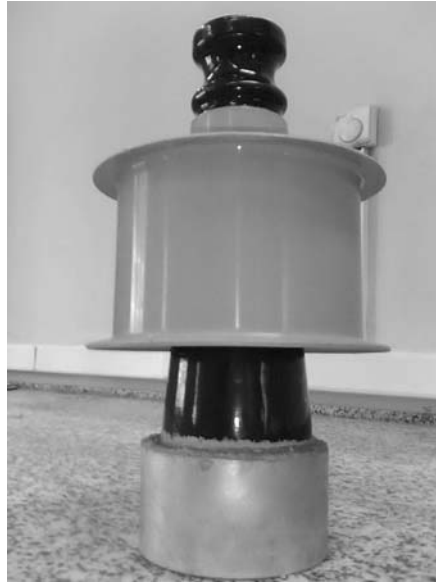
شکل ۵- نمونه مقره سرامیکی- پلیمری ساخته شده
