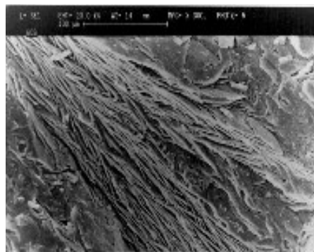
شکل ۹- ریزساختار نمونه GC.۶ پس از عملیات حرارتی (بزرگنمایی ۳۰۰)
